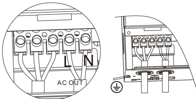
注意：接地线缆尽量用粗线径（导线截面积不小于  $4mm^2$ ），接地点尽量靠近一体机，接地线越短越好。
