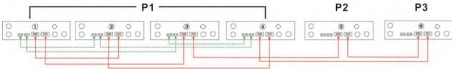
警告：请勿在不同相位的逆变器之间连接均流电缆，否则可能会损坏逆变器。
