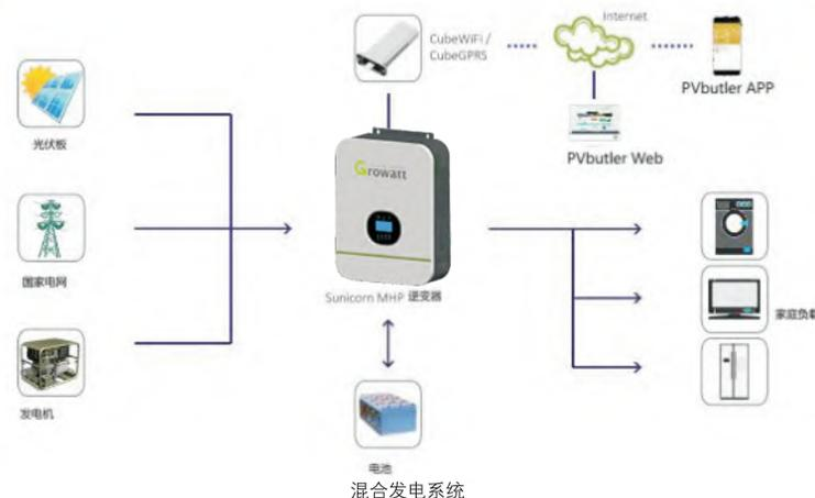
这是一款多功能离网型太阳能逆变器,集成MPPT太阳能充电控制器,高频纯正弦波逆变器和UPS功能模块于一体,非常适合离网后备电源和自发自用系统。高频变压器设计使得机器在精小的尺寸下还能提供可靠的功率转换。
