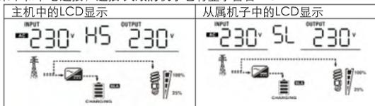
步骤5: 如果没有故障报警, 则完成安装并联系统。
