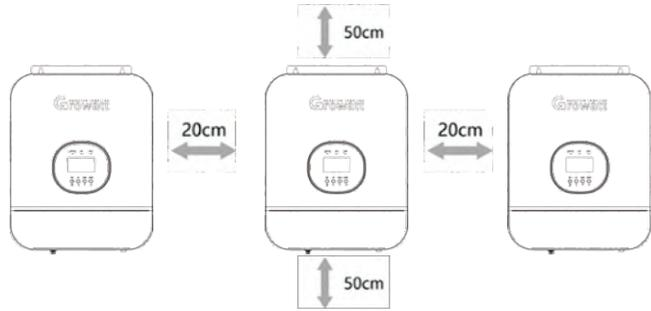
注意：为保证正常散热，机器左右间距至少20cm，上下间距至少50cm。确保每一台机器安装在同一水平线上。
