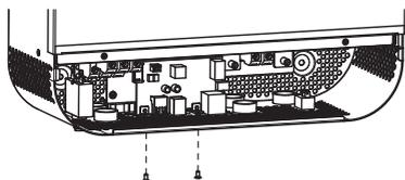
Step 3: 按照下图所示, 移出2颗螺丝, 移出2针排线中14针排线, 拿出跟通讯模块下面的底板
