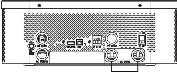
一旦装置正确安装并且电池连接良好，只需按开/关按钮（位于机壳按钮上）打开装置。
