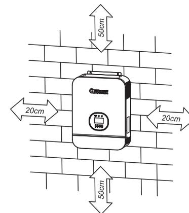
拧上四颗螺钉安装设备。建议使用M4或M5螺丝。
