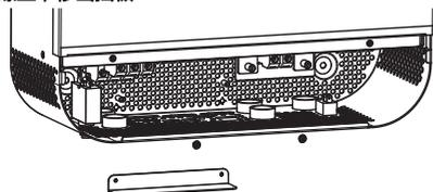
Step 5: 安装新的并机模块, 拧紧螺丝
