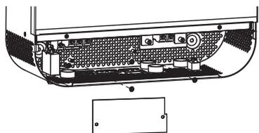
Step 4: 按照下图所示, 移出2颗螺丝, 移出挡板
