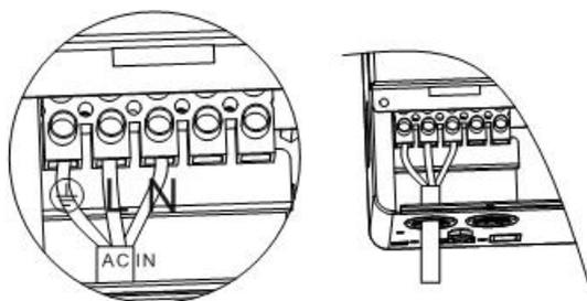
③根据下图所示线缆顺序和端子位置，正确接上交流输出线，请先接地线，再接火线和零线，地线通过 O 型端子接到机箱接地螺丝孔。
