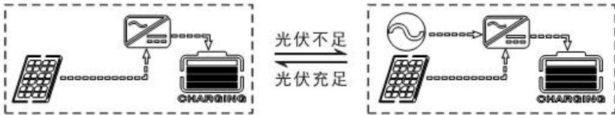
4、仅光伏充电(Only Solar):仅光伏充电，不启动市电充电。这种方式为最节能方式，电池电能均来自于太阳能，通常在光照条件好的地区使用。
